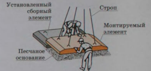
УСТАНОВКА ЖЕЛЕЗОБЕТОННОГО ПОДКОЛОННИКА
