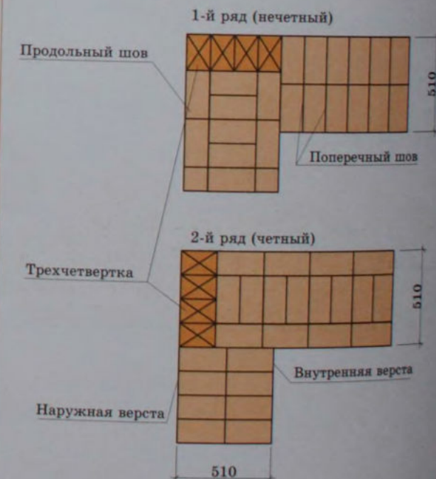
Кладка углов стен толщиной в 2 кирпича
