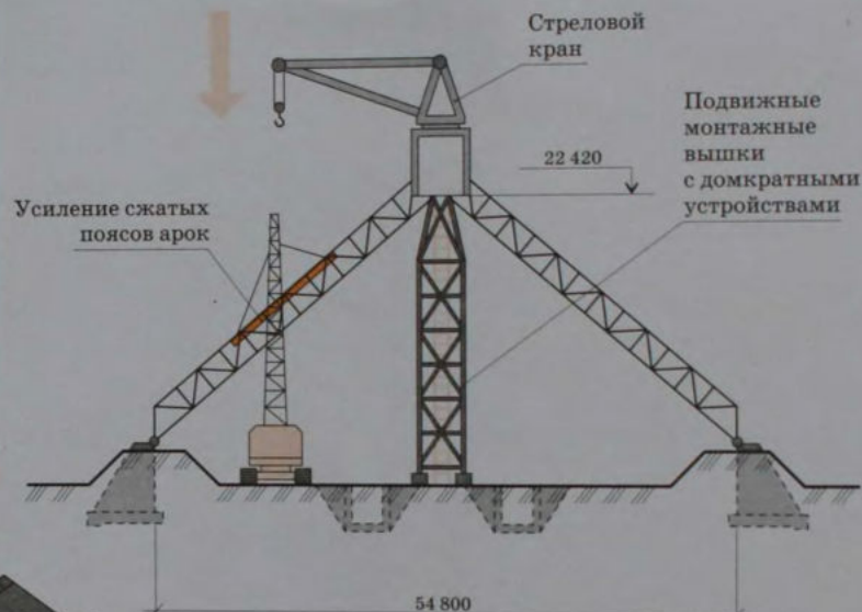
МОНТАЖ КОНСТРУКЦИЙ КРУПНОБЛОЧНОГО ПОКРЫТИЯ СКЛАДА
