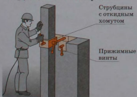
МОНТАЖ СТЕНОВОЙ ПАНЕЛИ Закрепление стеновой панели струбциной с хомутом
