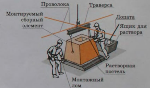
РИХТОВКА СТЕНОВОГО БЛОКА
