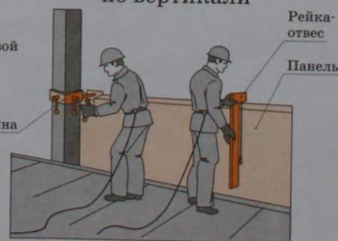
Выверка стеновой панели по вертикали
