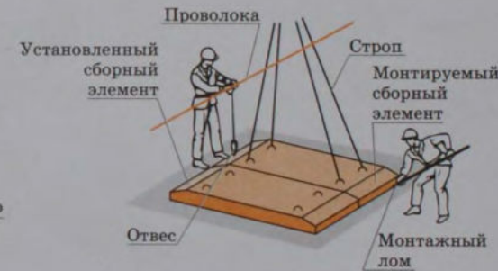
УСТАНОВКА СТЕНОВОГО БЛОКА
