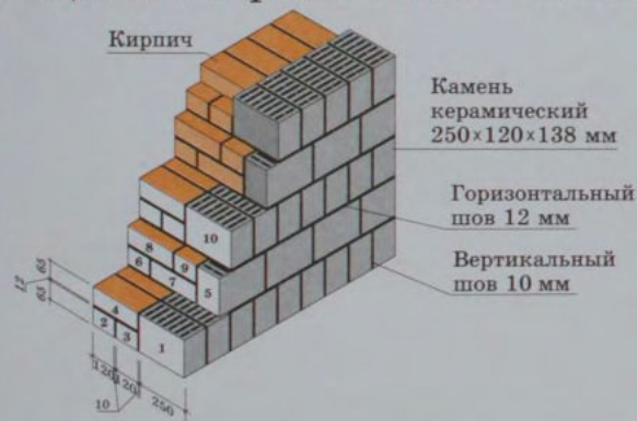
Кладка из кирпича с облицовкой керамическим камнем
