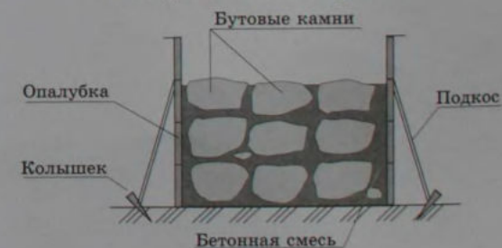
Бутобетонная кладка в опалубке
