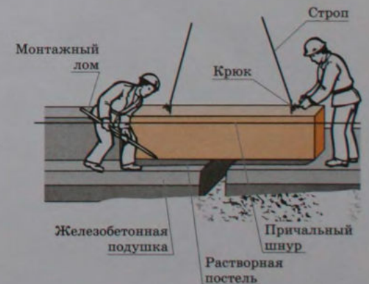
РИХТОВКА СТЕНОВОГО БЛОКА
