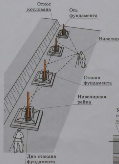
ПРОВЕРКА ОТМЕТКИ ДНА СТАКАНА ФУНДАМЕНТА
