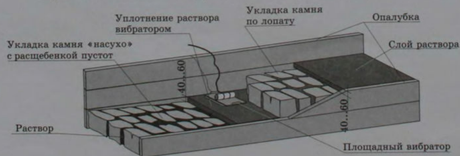
Бутобетонная кладка с виброуплотнением
