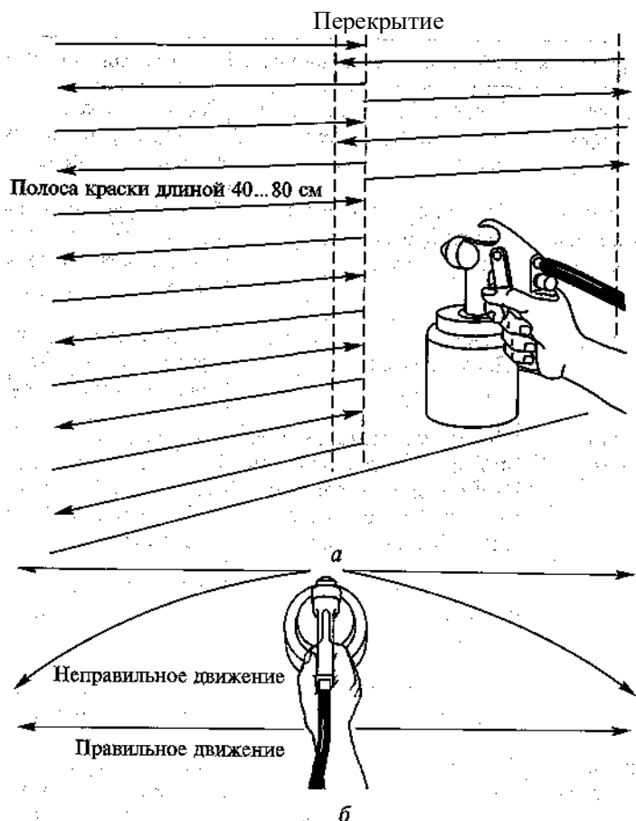
Рис. 13.5. Нанесение окрасочного состава пистолетом-краскораспылителем: a — направление распыления; б — направление движения пистолета
