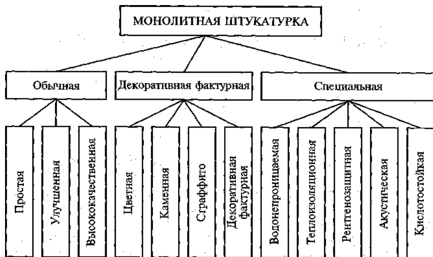
Рис. 2.1. Классификация монолитной штукатурки
