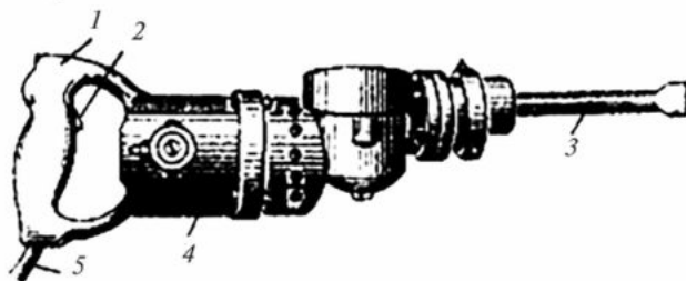
Рис. 1.1. Электрический отбойный молоток: 1 — рукоятка; 2 — выключатель; 3 — зубчатка; 4 — корпус; 5 — электропровод
